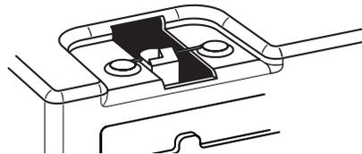
Usted puede poner el Flotador de Nivel del Agua en las posiciones "alta" o "baja". Ambas posiciones apagarán automáticamente el deshumidificador. Para ajustar el nivel de agua, empuje el flotador hacia la derecha o la izquierda hasta que encaje en su lugar.
