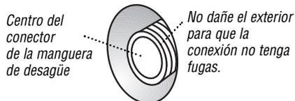
2. Perfore únicamente el centro del conector de la manguera de desagüe. Use una broca de 1/4 pulg. como mínimo.
