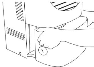
1. Levante el balde utilizando las dos agarraderas laterales. Tire del balde hacia usted, para sacarlo.
