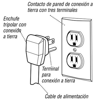
Para su seguridad personal, este deshumidificador debe estar conectado a tierra. Este deshumidificador está equipado con un cable de alimentación con un enchufe tripolar con conexión a tierra.
