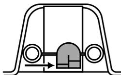
La posición "Baja": deslice el Flotador de Nivel del Agua a la posición de "baja", al lado derecho de la abertura, para que el balde esté más liviano para transportarlo. El deshumidificador se apagará automáticamente cuando el balde esté  $\frac{1}{2}$  lleno.
