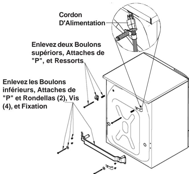
6. Retirer les pièces suivantes de l'arrière de la laveuse :
