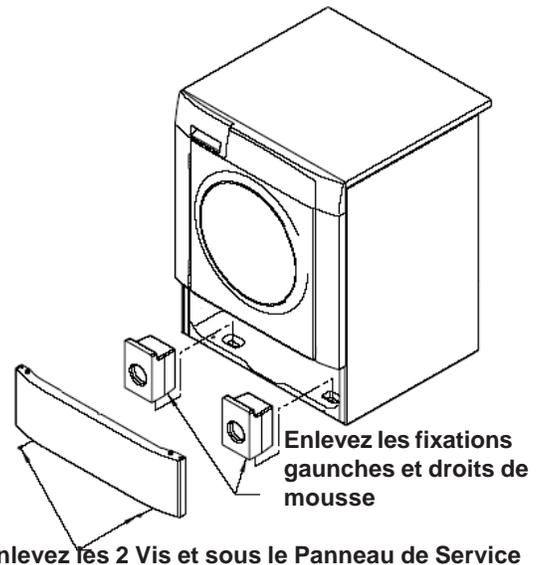
11. Enlevez les deux (2) blocs de mousse de polystyrène situés sous le tambour (un ruban jaune entoure les articles à enlever). Soulevez vers le haut sur le tambour, inclinez la base des blocs de mousse vers l'intérieur vers l'arrière de la laveuse jusqu'à être libre, puis tirez-les.
