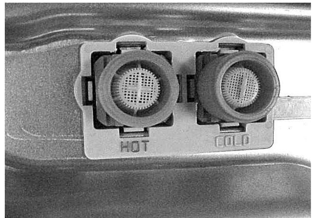
4. Brancher les boyaux d'arrivée d'eau aux robinets d'eau CHAUDE et d'eau FROIDE en les serrant bien à la main, puis les serrer de 2/3 de tour à l'aide de pinces. Ouvrir les robinets et s'assurer qu'il n'y a pas de fuite.
