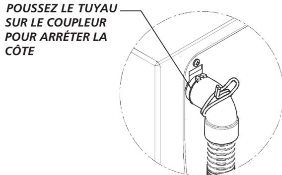
3. En utilisant des pinces, serrez les oreilles de la attache de ressort et placez la attache ainsi les oreilles de attache alignent avec et entrent en contact avec les étiquettes sur la tuyau de drain. Ceci assure l'endroit approprié de la attache pour empêcher des fuites.
