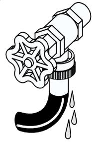
**NE FAUS-SEZ PAS LE FILETAGE ET NE SERREZ PAS TROP CES RACCORDEMENTS.**
